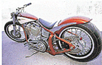
↑ソフテイルフレームをカットして短くしたりグリップにベークライトを使用したり、見ただけでは分からない箇所のディテール満載
