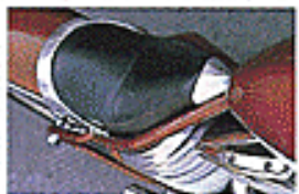
↑細身で薄いシートの前後にはアルミ削りだしのパーツでアクセントを付ける。オイルタンクのカバーもワゴンオフ。流麗なフィンが特徴的
